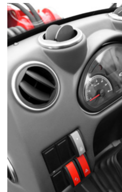
nové, větší výstupy vzduchu - intenzivní cirkulace /optimalizované uspořádání přepínačů
