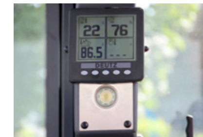
nový informační display na bočním sloupku kabiny (u řady 86- a 96- std.)
