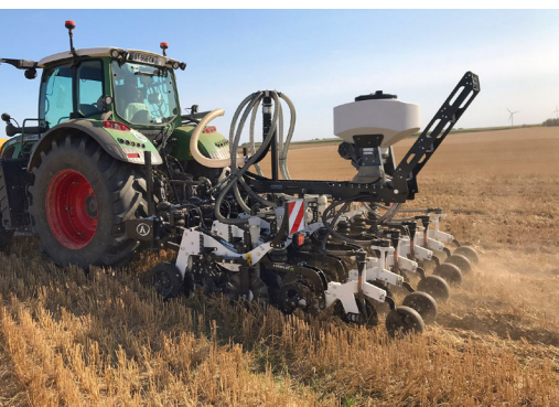
Jednořádkové (např. řepka) nebo dvouřádkové výsevní jednotky (např.pšenice)
